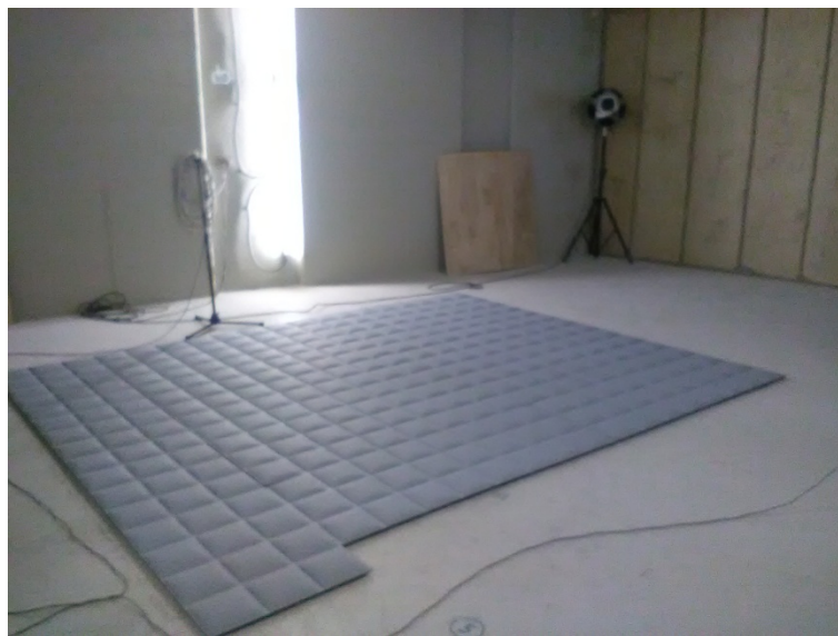
Figura 6_Camera Riverberante con Campione
