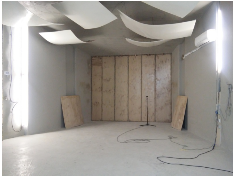
Figura 5_Camera Riverberante Vuota
